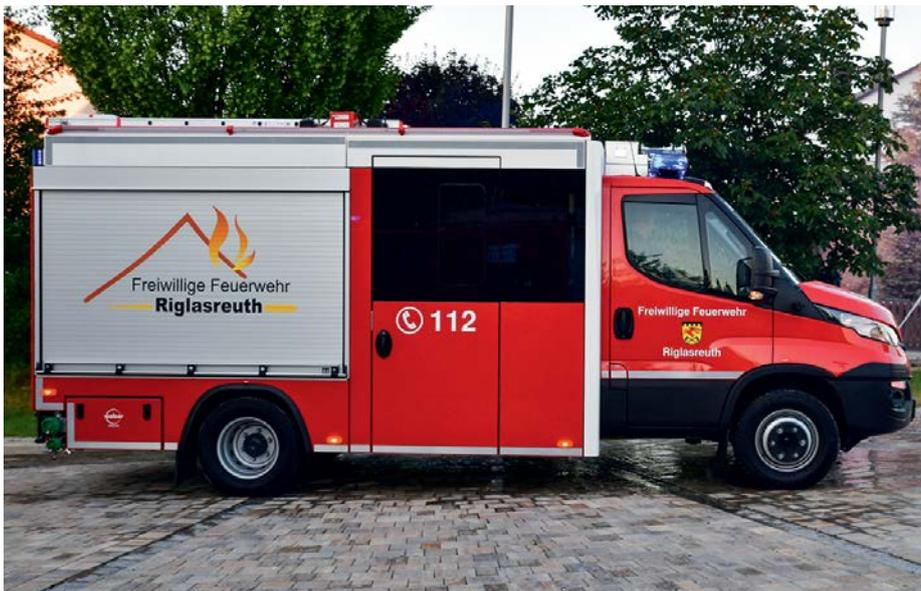
**Tragkraftspritzenfahrzeug Wasser (TSF-W) der Feuerwehr Riglasreuth**
